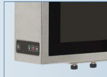
Botonera lateral accesible para encendido/apagado y reset del equipo
